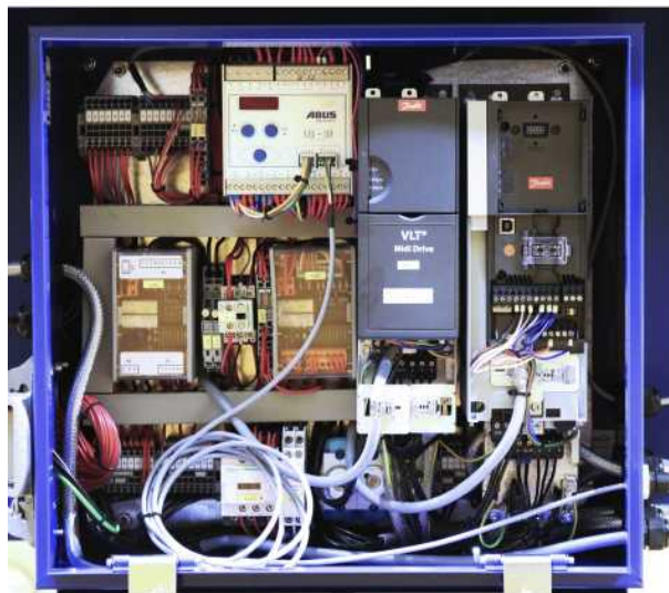
Système électrique 3 ABUS avec variateur de fréquence ABULiner Translation et/ou Levage
