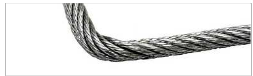
Le câble est coudé. Ce coudage est dû p.ex. à une force extérieure exercée sur le câble.
