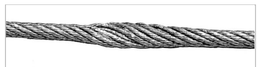
Une partie du câble est aplatie. Cela est dû p.ex. à un écrasement du câble.
