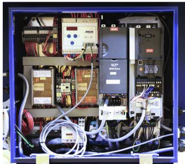
ABUS Electric 3 con convertidor de frecuencia ABULiner traslación y/o elevación
