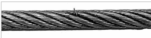
Drahtbruch mit abstehendem Draht.
