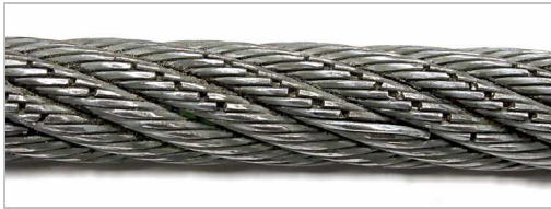
Mehrere Drahtbrüche. Drahtbrüche sind Spuren des normalen Verschleißes des Seils. Sie entstehen, wenn das Seil unter Last auf den Seilrollen gebogen wird.
