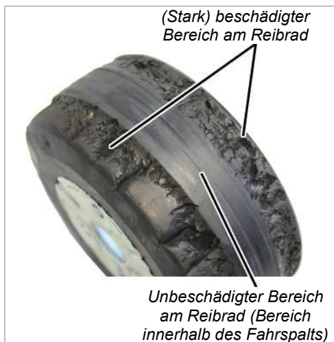
Beispiel für Schäden am Reibrad.
