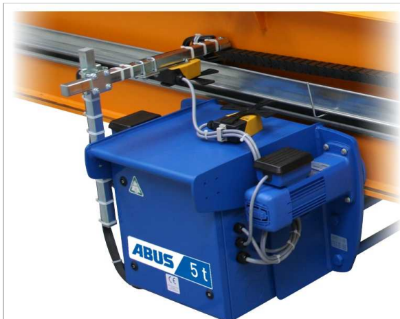
Interrupteur à levier en croix servant de fin de course du chariot de direction
