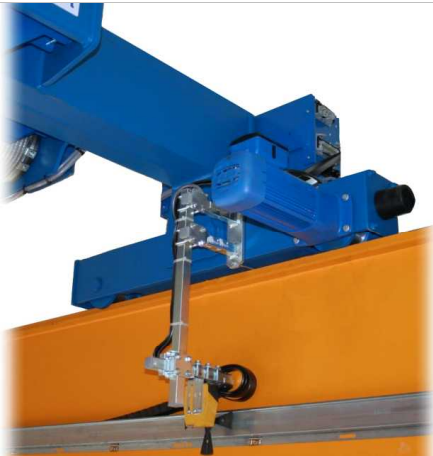
Interrupteur à levier en croix servant de fin de course du chariot de direction
