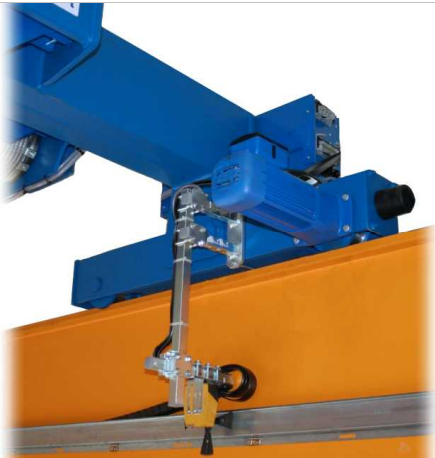
Interruptor de cruceta como interruptor fin de carrera del carro
