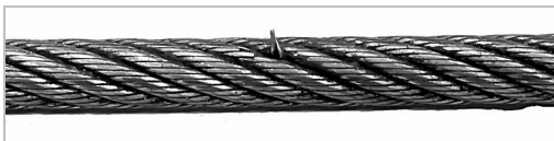
Drahtbruch mit abstehendem Draht.
